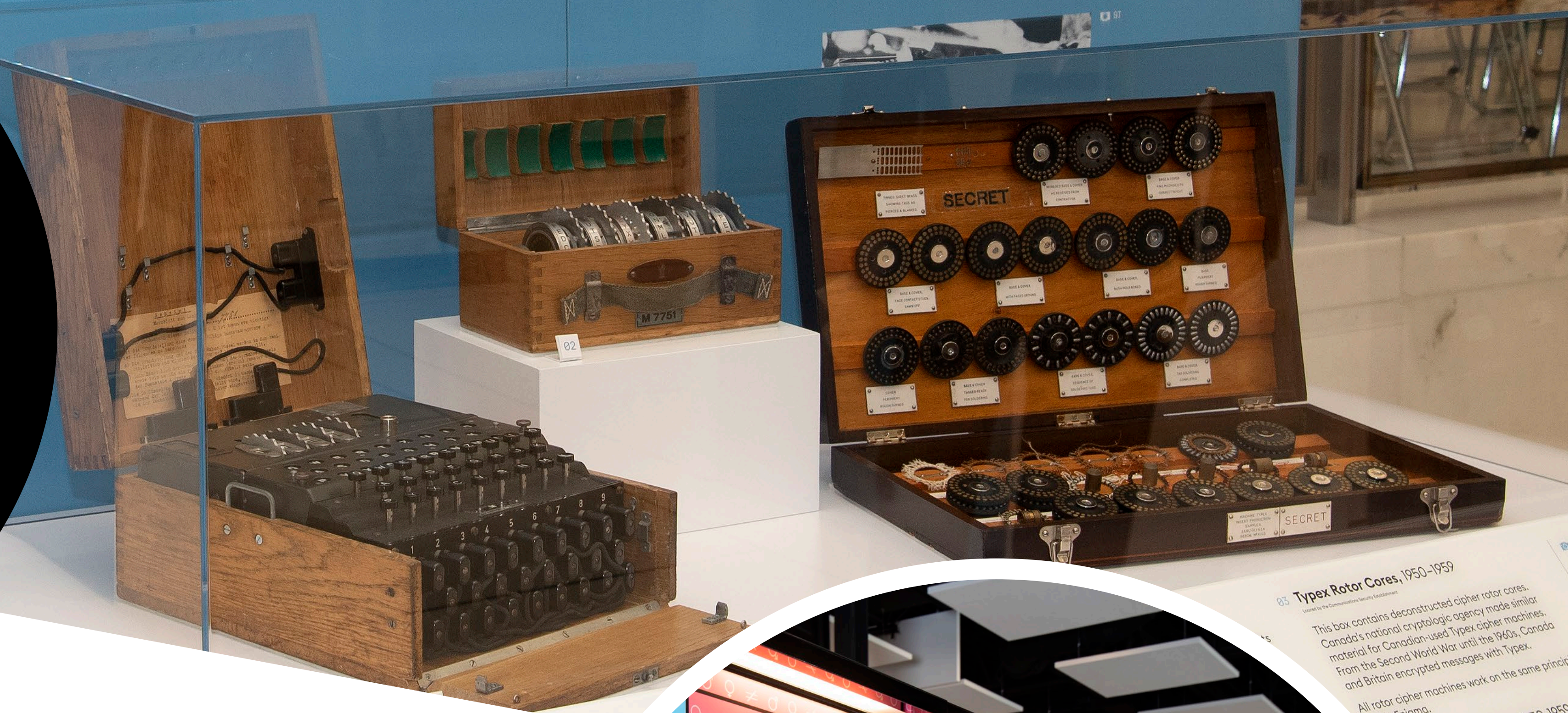
Noyaux de rotors Typex, 1950-1959 Cette boîte contient des noyaux de rotors démontés. L'organisme national de cryptologie du Canada a fabriqué de l'équipement semblable pour le chiffrement Typex utilisé au Canada jusqu'aux années 1960. Le Canada et le Royaume-Uni ont chiffré des messages grâce à ces machines. Toutes les machines à rotors fonctionnent sur le même principe.
